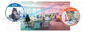
Bei konventionellen Kassettengeräten wird gekühlte Luft über 4 Luftleitlamellen in den Raum eingeblasen. Das führt zu einer ungleichmäßigen Durchkühlung des Raumes und zu einem differenzierten Temperaturempfinden. Personen, die dem direkten Luftstrom ausgesetzt
