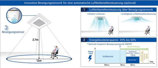
Die Luftleitlamellen werden im normalen Kühlbetrieb über den Bewegungssensor automatisch gesteuert. Sich im Raum aufhaltende Personen werden vom Sensor erfasst. Die Luftleitlamellen werden so gesteuert, das Personen nicht direkt dem Luftstrom ausgesetzt sind. Die On/Off Funktion sorgt für die automatische Ein- und Abschaltung des Gerätes wenn sich keine Person im Raum befindet. Ideal für Büros, Praxen und Behandlungsräume. Energieersparnis bis zu 50%.
